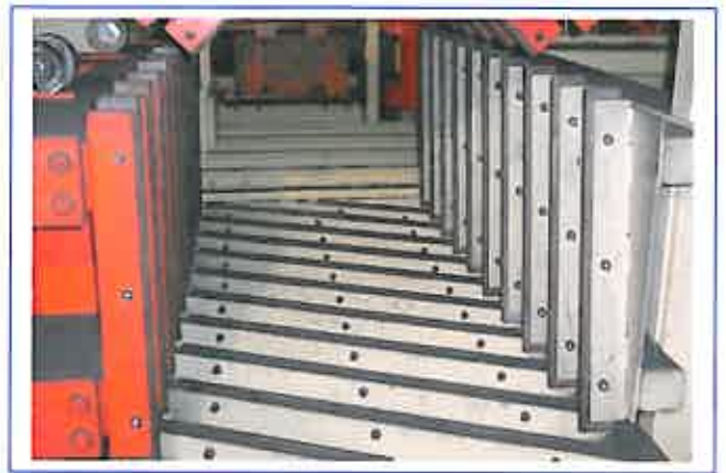
Décapage de surface longue d'anode
